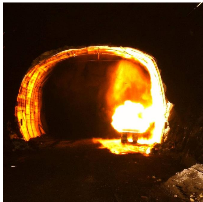
Essai incendie sur matelas de PE www. NRK.no
