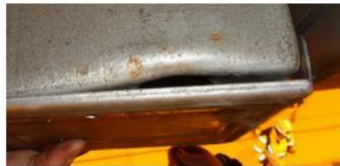
Figure 34 : déformation d'un boîtier capteurs (ACC 2 336 1)
