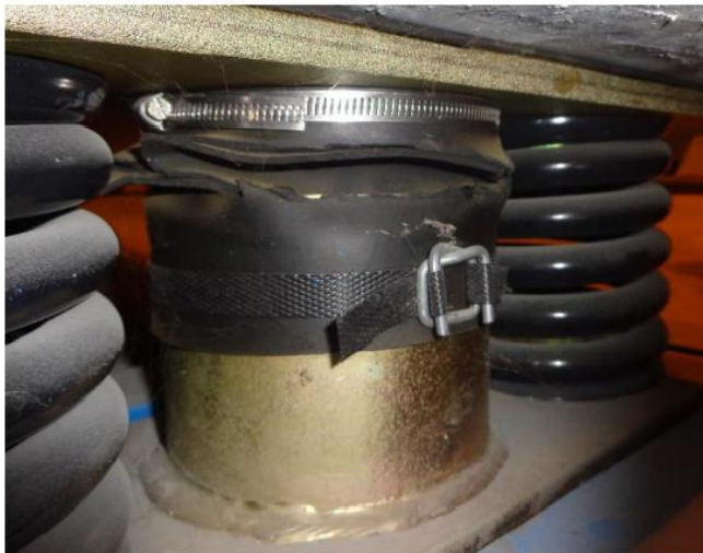
Figure 32 : caoutchouc de l'amortisseur central déchiré
